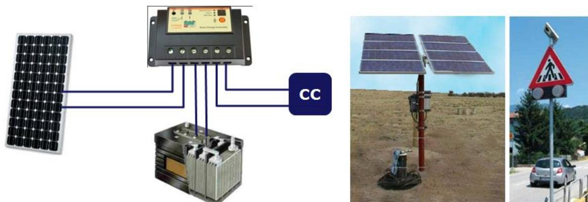
**Figura 112. Sistema aislado de con baterías de almacenaje y consumo en corriente continua**
