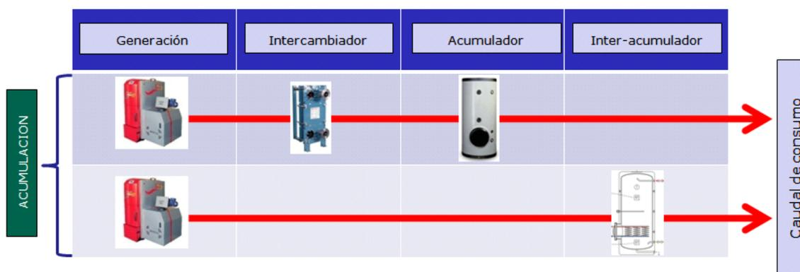
**Figura 22. Sistema de producción de ACS por acumulación**
