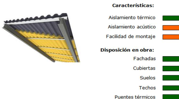
**Figura 25. Lana mineral. Evaluación de funcionamiento y eficacia en la disposición en obra**
