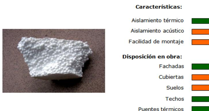
**Figura 26. Poliestireno expandido. Evaluación de funcionamiento y eficacia en la disposición en obra**
