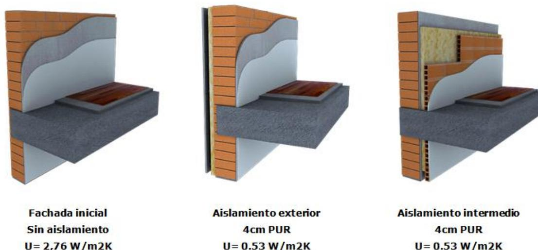
Figura 20. Transmisión térmica según la posición del aislamiento
