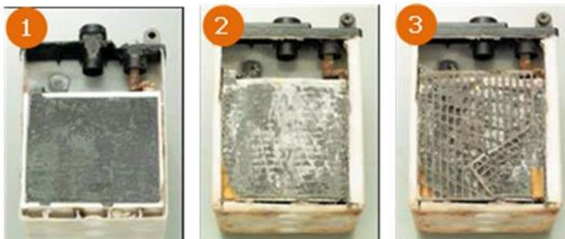
**Figura 128. Efecto de la sulfatación**
