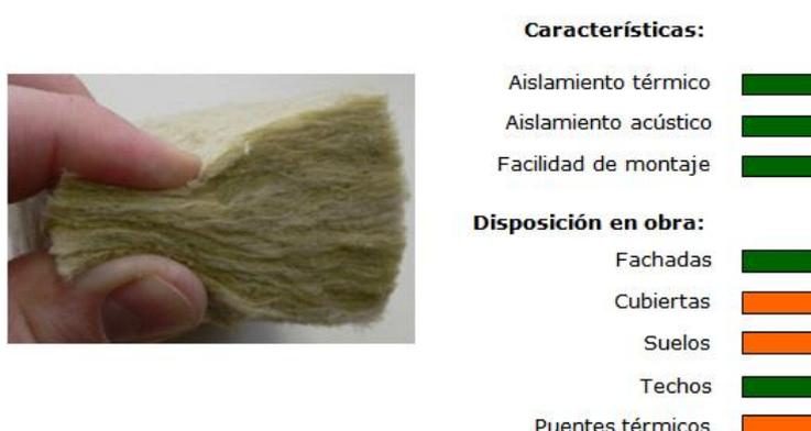
**Figura 24. Lana mineral. Evaluación de funcionamiento y eficacia en la disposición en obra**
