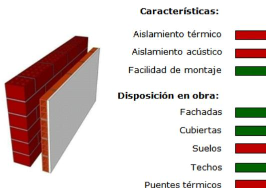
**Figura 23. Cámara de aire. Evaluación de funcionamiento y eficacia en la disposición en obra**
