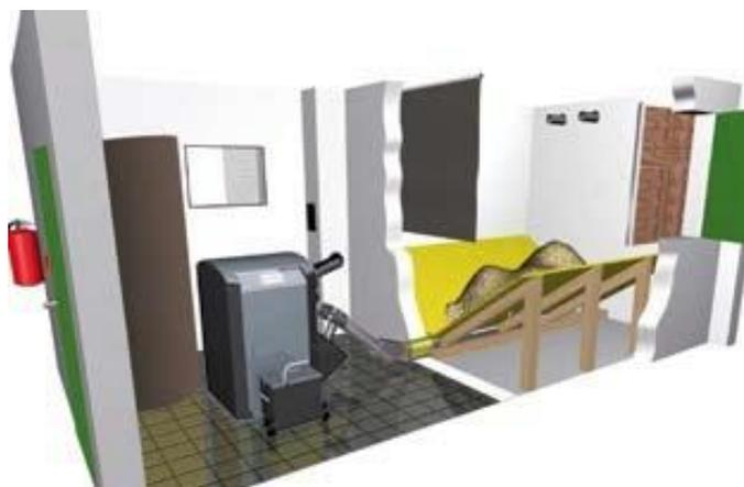
**Figura 28. Sistema de conexión mediante tornillo sin fin rígido y embocadura en ángulo**
