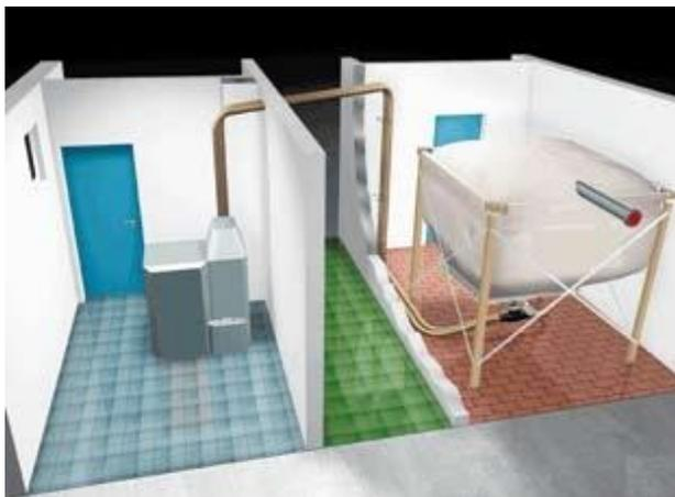
**Figura 27. Sistema neumático de impulsión de biocombustible del silo a la caldera**
