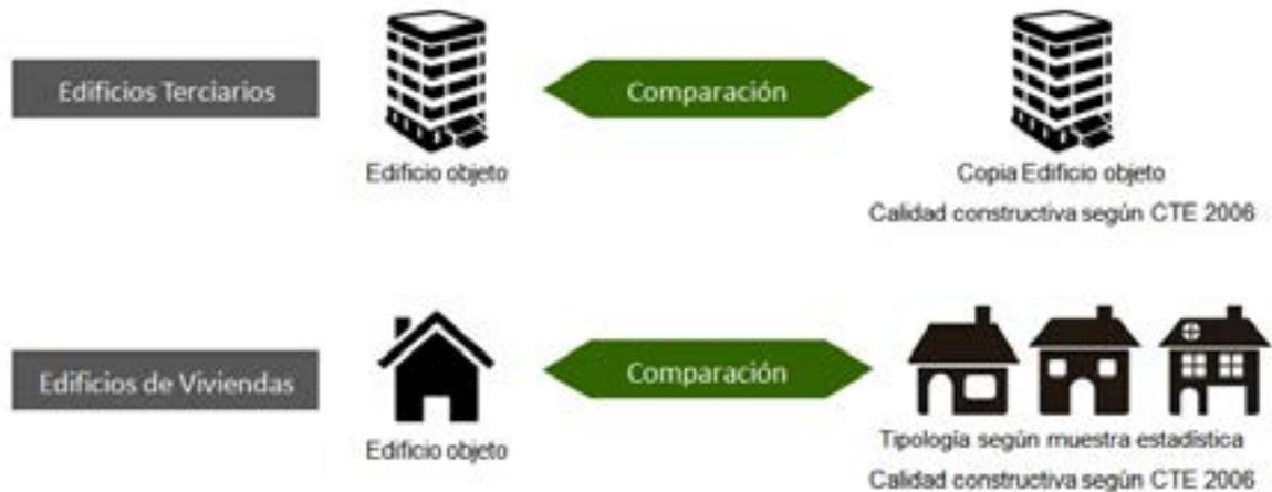
**Figura 4.** Procedimiento de comparación en la certificación energética.
