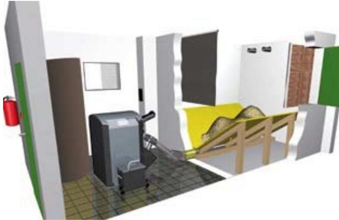
*Figura 22. Sistema de conexión mediante tornillo sin fin rígido y embocadura en ángulo*
