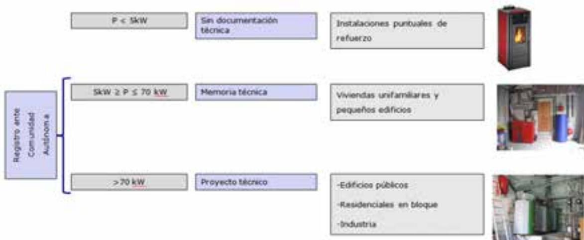
Figura 8. Tipología de calderas según su potencia
