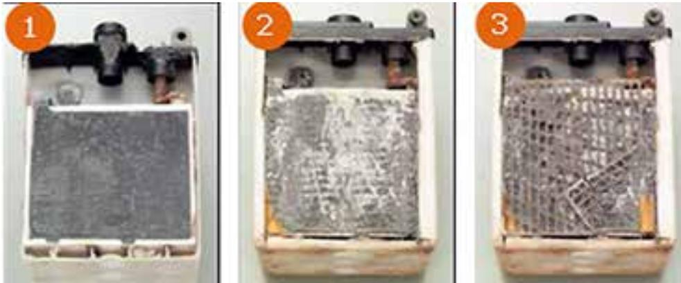
Figura 54. Efecto de la sulfatación
