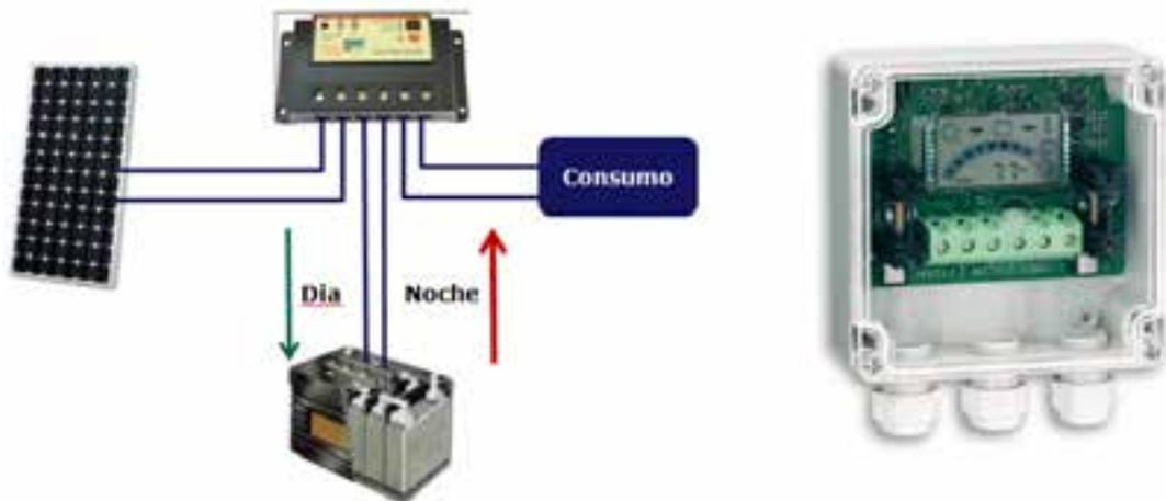
Figura 64. Esquema de funcionamiento de un regulador de carga
