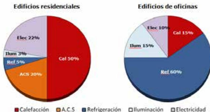
Figura 1. Distribución del consumo de energía en edificios de la Península
