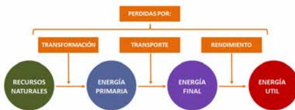
Figura 1. Relación entre energía primaria y energía final
