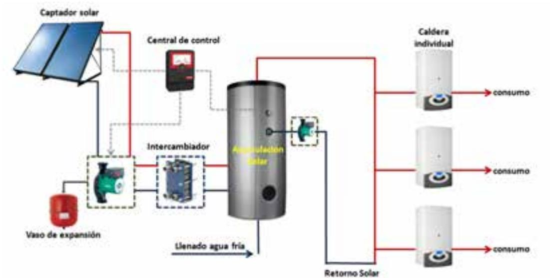
Figura 16. Esquema de sistema de apoyo distribuido de producción de ACS
