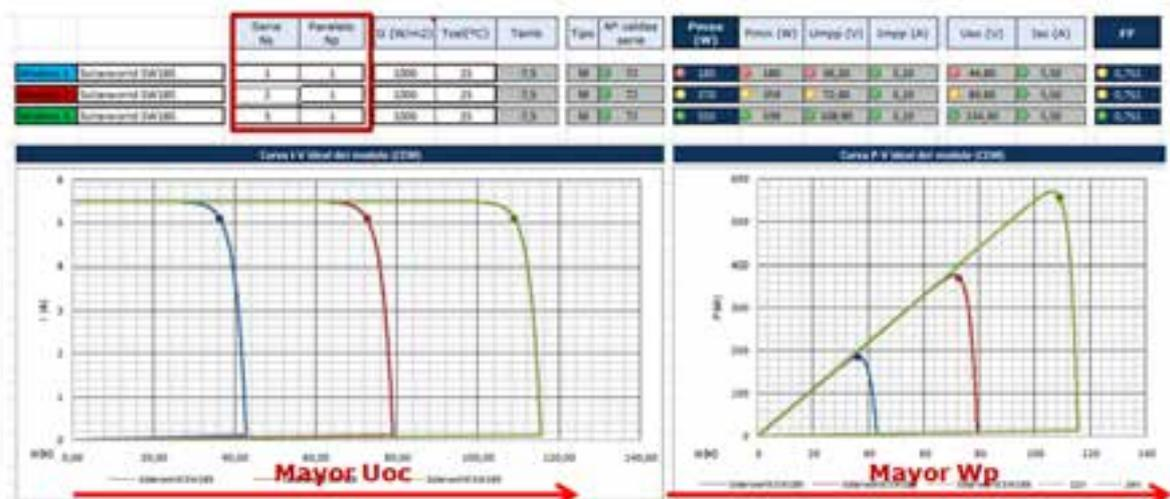
Figura 30. Variación de las constantes de intensidad, tensión y potencia en la asociación de módulos en serie
