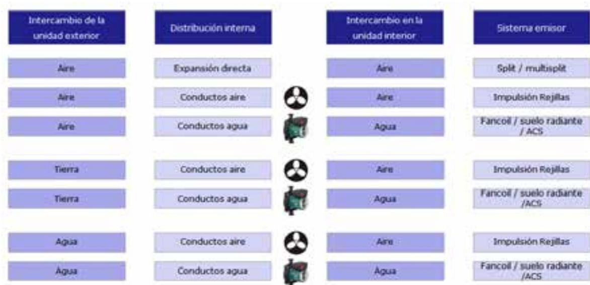
Figura 3. Tipología de sistemas de climatización
