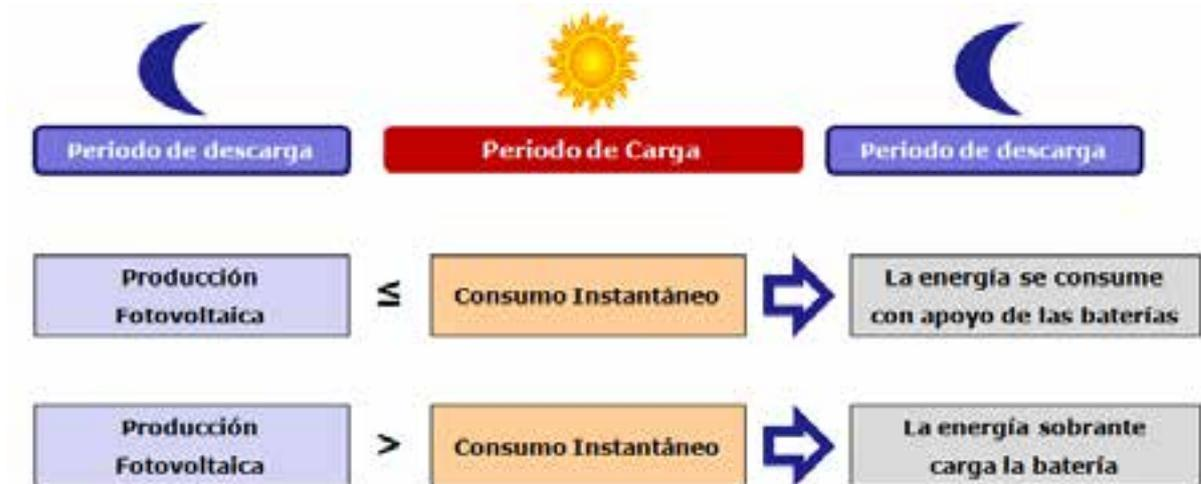
Figura 45. Esquema de regulación de la carga y vaciado de una batería fotovoltaica
