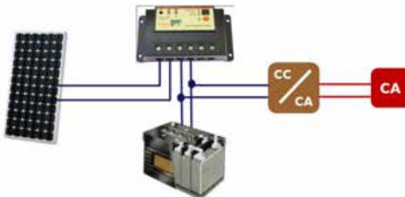
Figura 40. Sistema aislado de con baterías de almacenaje y consumo en corriente alterna
