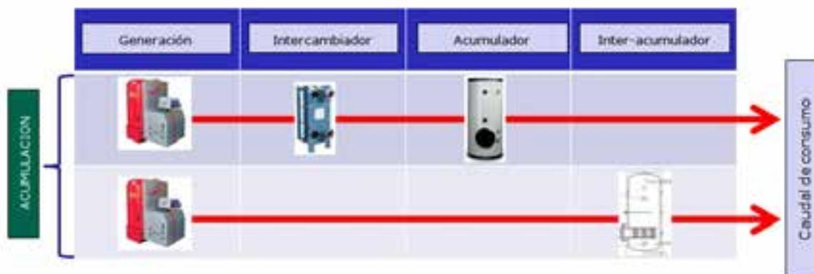
Figura 16. Sistema de producción de ACS por acumulación
