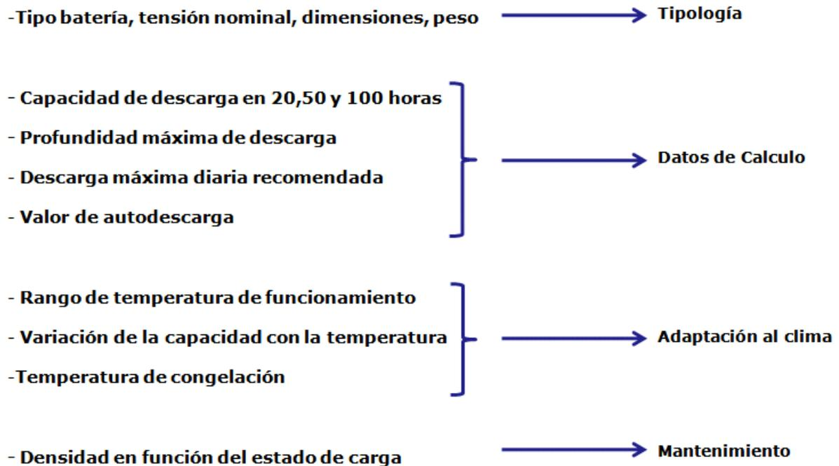
Figura 63. Datos que debemos solicitar al fabricante de una batería
