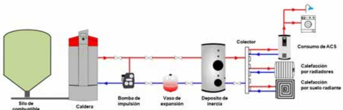
Figura 6. Esquema de un sistema de biomasa térmica
