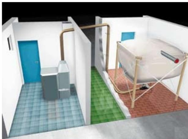
Figura 21. Sistema neumático de impulsión de biocombustible del silo a la caldera
