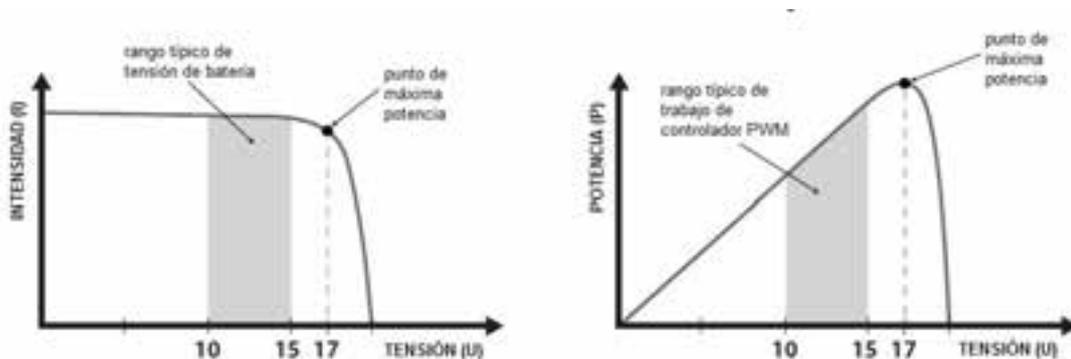
Figura 70. Mejora en la regulación con buscador de máxima potencia (MPPT)
