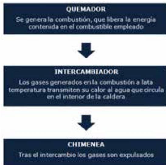
Figura 9. Esquema de funcionamiento de una caldera
