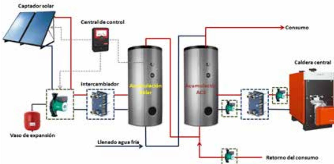
Figura 15. Esquema de sistema centralizado de producción de ACS
