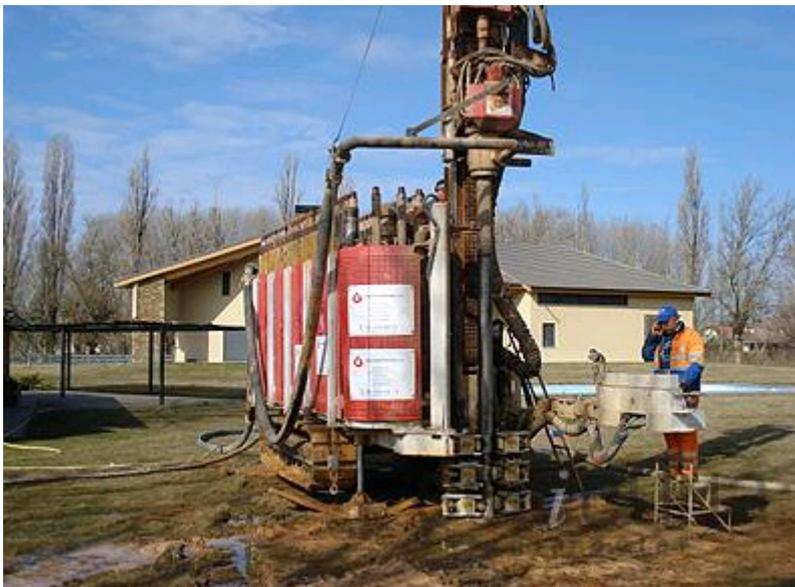
*Figura 11. Equipo de perforación para instalaciones geotérmicas*
