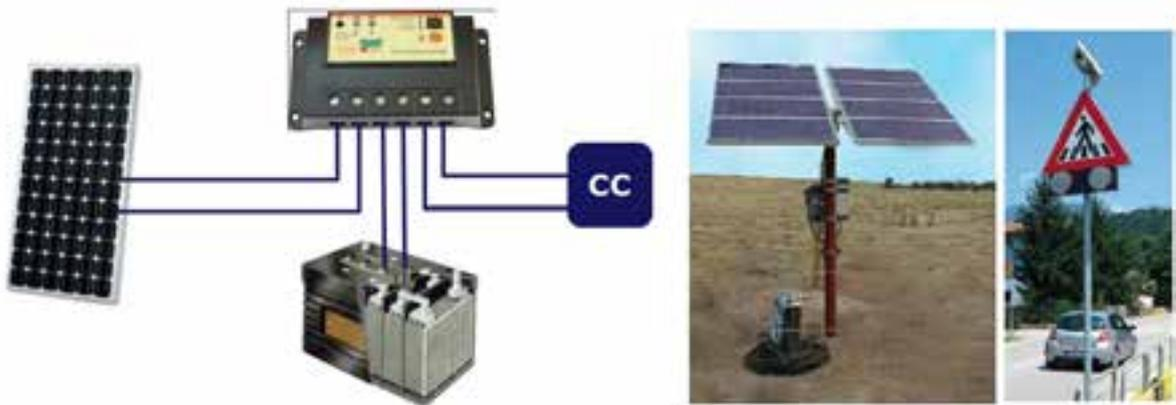
*Figura 38. Sistema aislado de con baterías de almacenaje y consumo en corriente continua*
