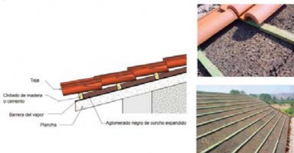
**Figura 19.** Aislamiento de cubiertas mediante corcho aglomerado.
