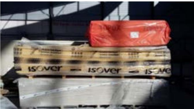
**Figura 23.** *Planchas embaladas mediante funda protectora de plástico*
