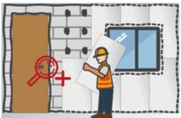
En el perímetro de puertas y ventanas, así como en los bordes de encuentros de pared y techo y pared-pared, se ha de aplicar un cordón continuo de adhesivo.
