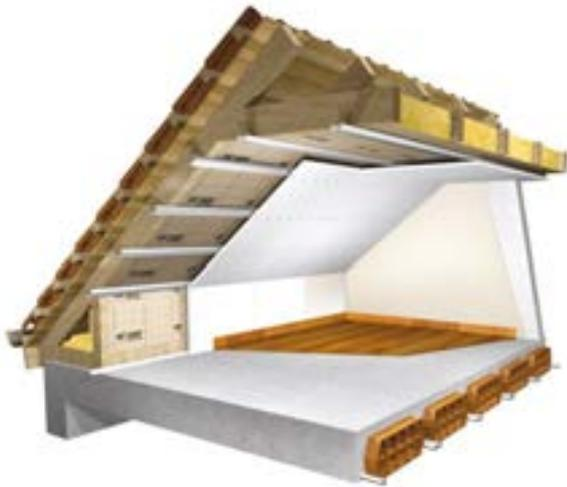
**Figura 62.** Aislamiento bajo cubierta habitable mediante mantas de lana de vidrio y acabado de placas de yeso laminado. Fuente: [www.isover.es](http://www.isover.es)
