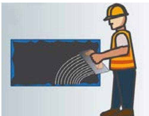
Figura 29. *Aplicación de la pasta de adhesivo sobre el panel aislante*
