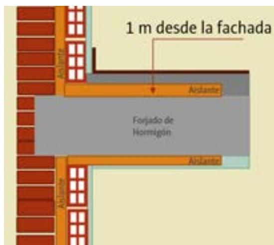
En el caso de los encuentros con los forjados, los puentes térmicos se pueden resolver cubriendo el canto con material aislante.
