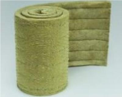
Se comercializa en forma de panel flexible (manta) de fibras de roca prensadas adheridas mediante resina. Puede disponer también de un recubrimiento con un laminado que actúa como barrera de vapor.
