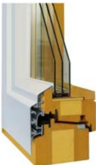
**Figura 7.** Ventana mixta, perfil de madera laminada, acabado exterior con perfiles de aluminio y acristalamiento triple de dos cámaras de aire 4/12/4/12/4. Fuente: [www.iberadria.com](http://www.iberadria.com)
