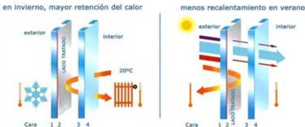
Figura 5. Comportamiento de los vidrios de aislamiento térmico reforzado. Fuente: CLIMALIT
