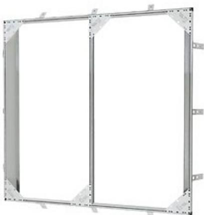
**Figura 4.** *Precerco de aluminio con cartabones para mantener la escuadría y garras para fijar a obra.*
