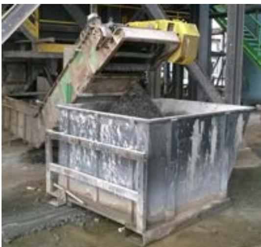
Figura 8. Sistema de evacuación de cenizas industrial. Imagen cedida por Garnica Plywood
