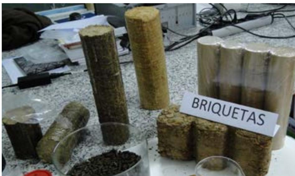
Figura 3. Varias clases de briquetas
