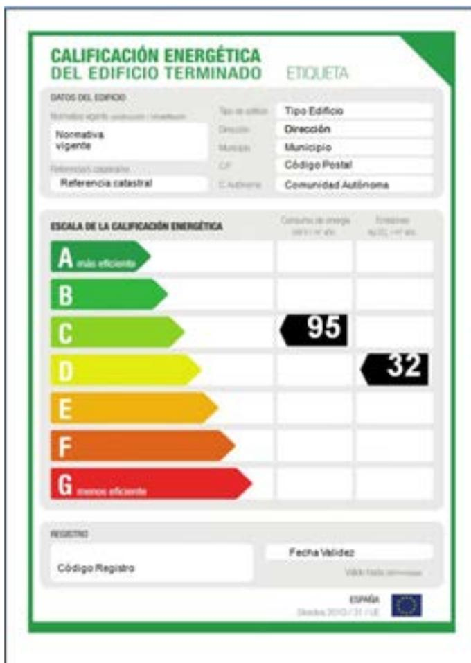
Figura 4. Etiqueta Energética con doble escala de calificación. La primera columna corresponde al consumo de energía primaria y la segunda a las emisiones de CO<sub>2</sub>.
