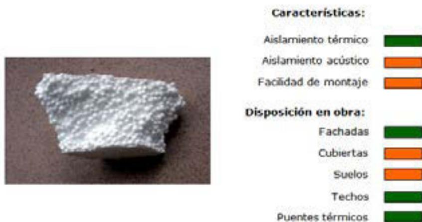
Figura 5. Poliestireno expandido. Evaluación de funcionamiento y eficacia en la disposición en obra
