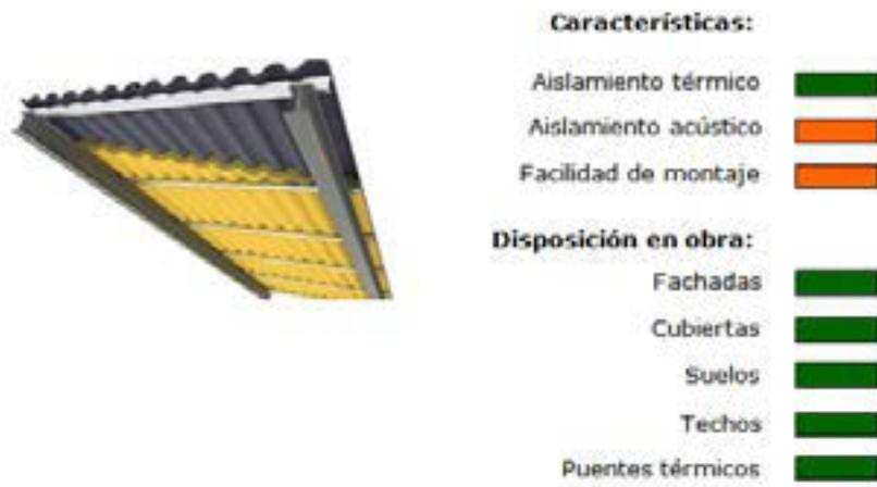
Figura 4. Poliuretano proyectado. Evaluación de funcionamiento y eficacia en la disposición en obra
