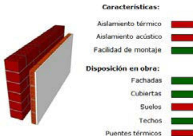
Figura 2. Cámara de aire. Evaluación de funcionamiento y eficacia en la disposición en obra
