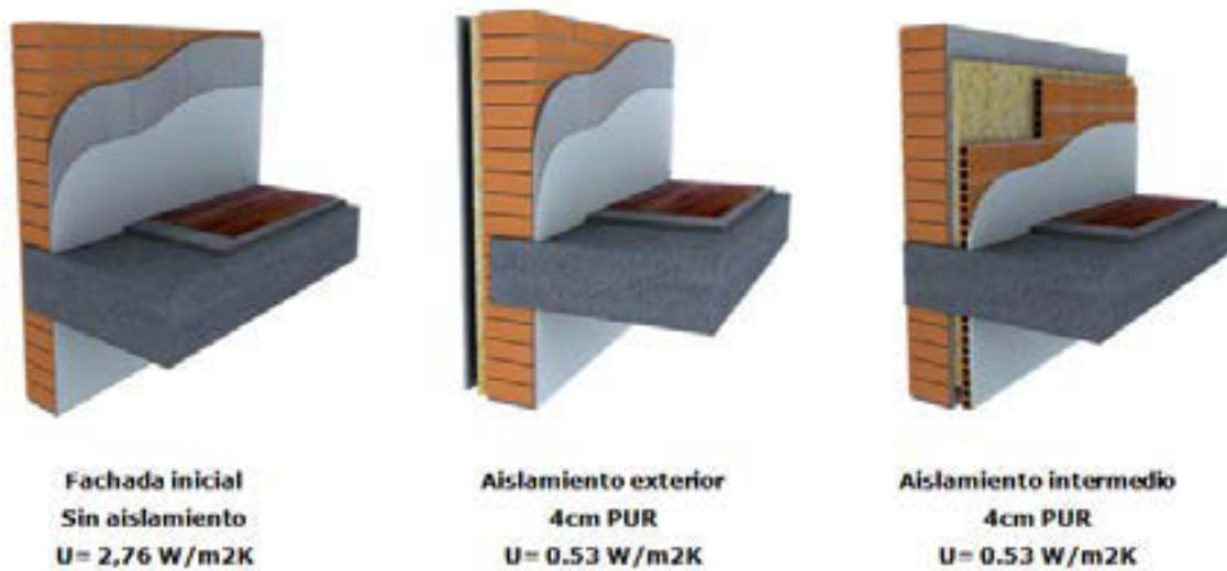
Figura 2. Transmisión térmica según la posición del aislamiento
