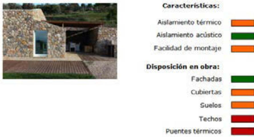
Figura 8. Aislamientos por acumulación. Evaluación de funcionamiento y eficacia en la disposición en obra
