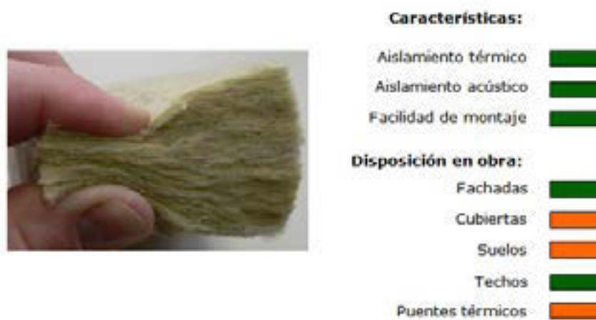
Figura 3. Lana mineral. Evaluación de funcionamiento y eficacia en la disposición en obra
