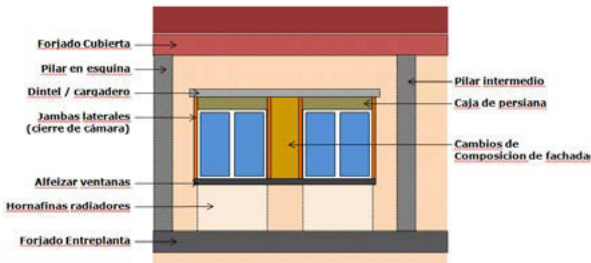
Figura 11. Puentes térmicos por pilares en fachada
